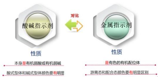
通过不同型体颜色的变化指示滴定过程中金属离子浓度的变化。
